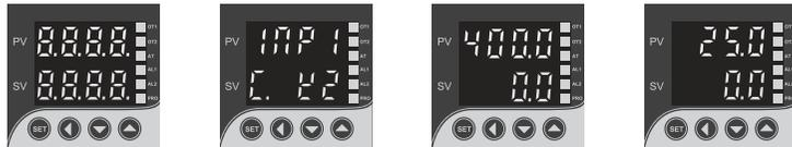
點亮所有LED及7段顯示器 顯示單位(°C)及輸入類型(K2) 顯示範圍 上限400.0°C / 下限0.0°C 開始使用
